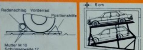
Nach dem Einstellen des Radanschlages sind die Befestigungsmuttern M 10 anzuziehen.
